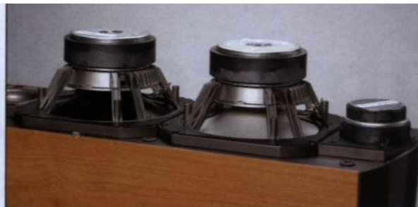
W Studio 40 mamy ten sam zestaw głośników. Membrany – z polipropylenu i aluminium
