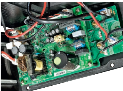
Elektronika Montisów jest bardzo rozbudowana, ponieważ zawiera zarówno zasilanie dla elektrostatu, jak też wzmacniacz i procesor DSP dla aktywnej sekcji niskotonowej. Jej większą część ulokowano na dwóch płytach przymocowanych do odkręcanego, tylnego panelu.
