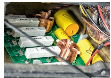
A jednak, nawet w tak aktywnej i zasilanej konstrukcji nie obyło się bez dużego zestawu elementów biernych, które służą do filtrowania (kształtowania charakterystyki) elektrostatu. Cieszy więc, że widać elementy dobrej jakości – kondensatory polipropylenowe i cewki powietrzne.
